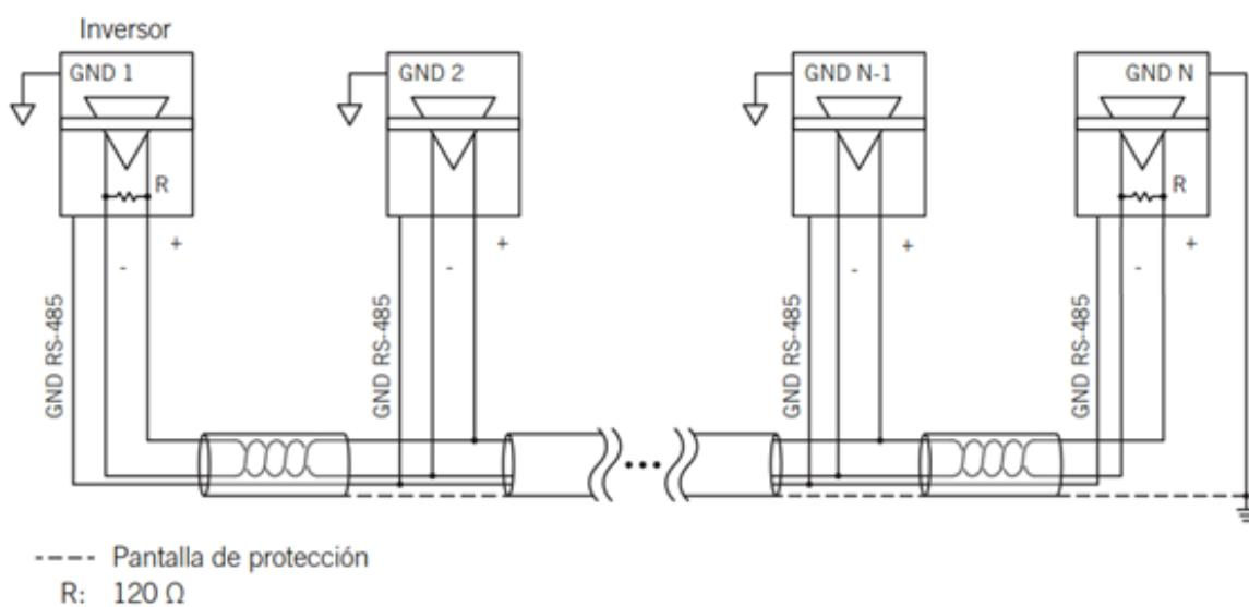
En la instalación del siguiente ejemplo se muestran varios inversores conectados en bus y un convertidor de medios al que se conecta un PC local.
